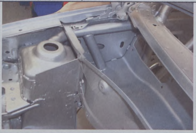
PHOTO N°(01) 11 Emplacement du bloc climatisation.
